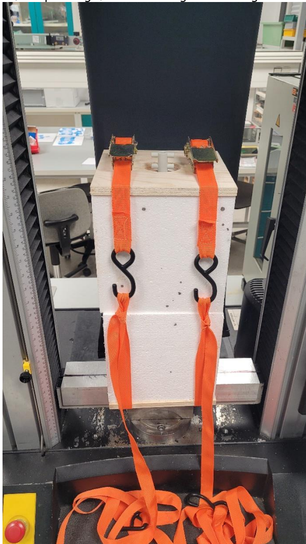
Prøveopstilling før udtrækning af isoleringsholder
